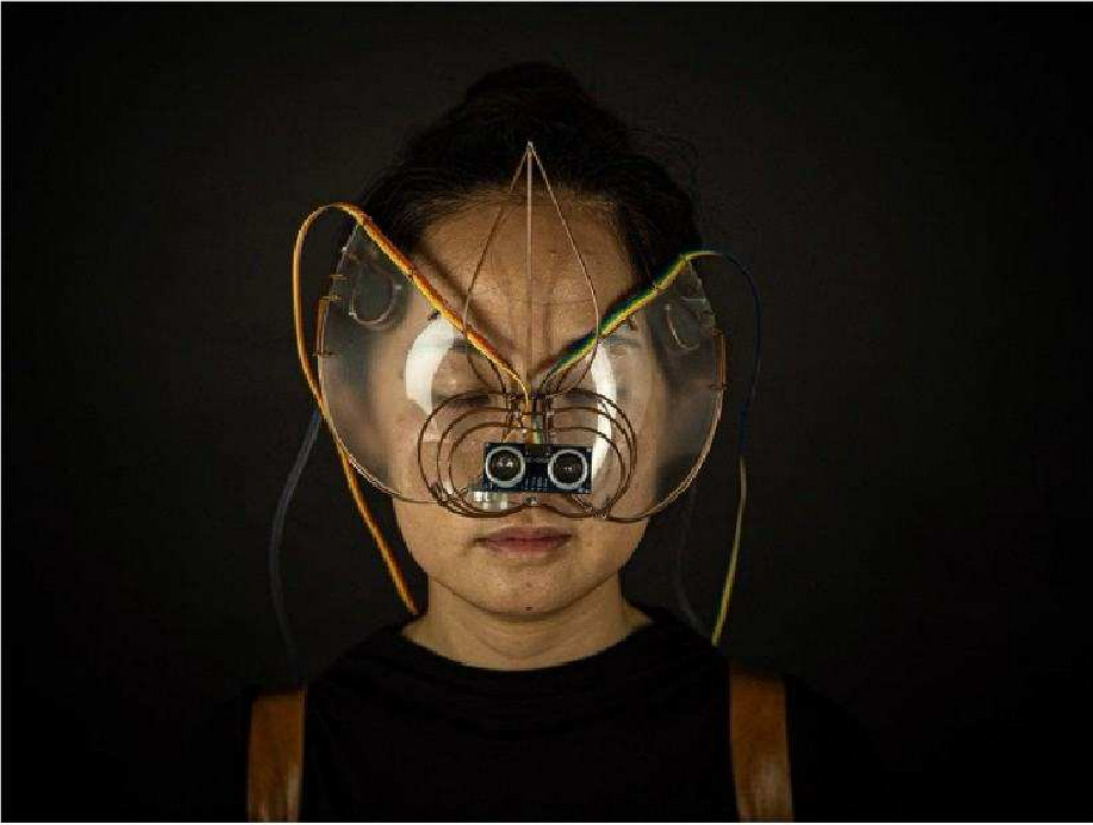
图 2-3 Interface（2021）：模拟蝙蝠的超声波定位感知增强人类感官的可穿戴设备 [11]
